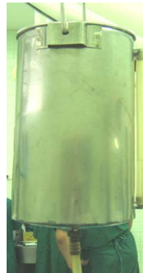
รูปที่ 4 ภาชนะที่ประดิษฐ์เสร็จแล้วพร้อมใช้ในการปฏิบัติงาน สามารถมองเห็นระดับน้ำผ่านสายซิลิโคน
