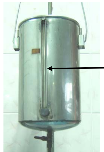
รูปที่ 7 ภาชนะมีหลอดแก้วใสบรรจุอยู่ สามารถมองเห็นระดับน้ำได้
